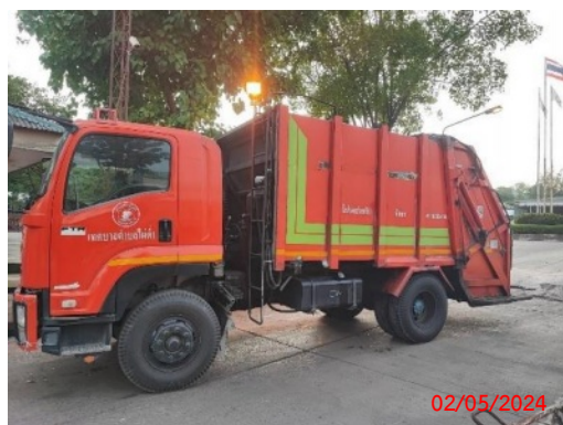
รูปที่ 2-71 รถขนส่งขยะชุมชนติดถังกลองรับน้ำเสีย
